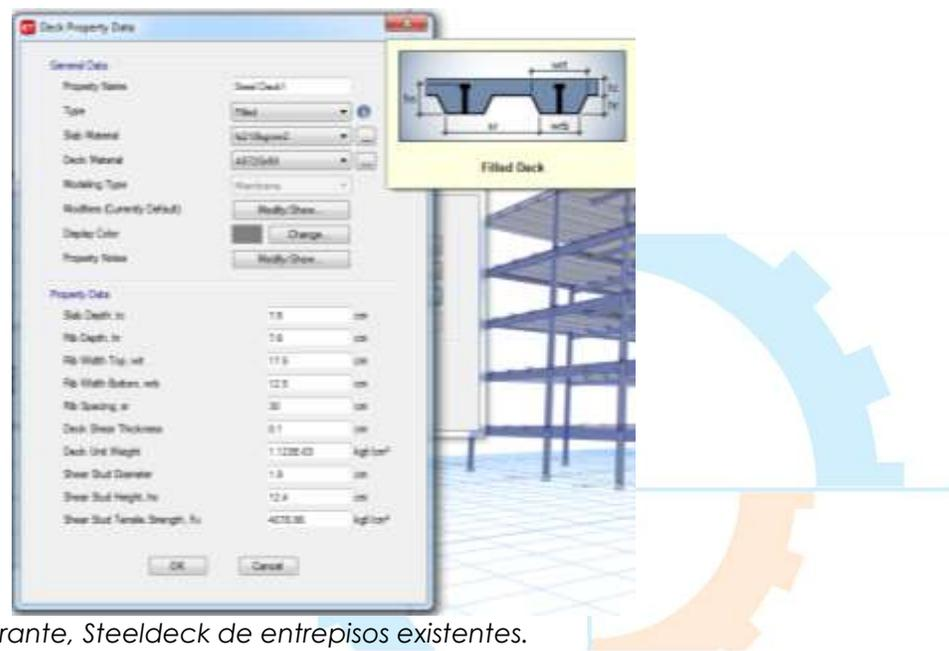
Figura 15. Losa colaborante, Steeldeck de entresijos existentes.
